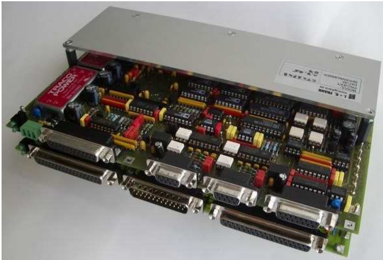
Bild: SMMU05-16S, Ausführung ohne Gehäuse, ohne Frontplatten Oberes Modul CTL274, darunter montiert MUX275
