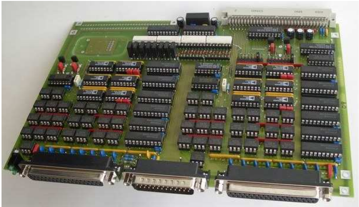
Bild: MUX275B in 16 Kanal-Ausführung mit SPSIO, HF-Teiler DIV252 unbestückt
